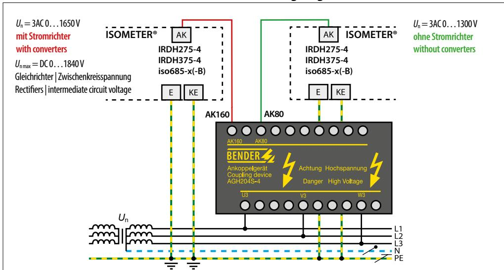
**i** Bei Systemen mit einer Netznennspannung von über 690 V und Überspannungskategorie III ist eine Sicherung für den Anschluss an das zu überwachende Netz vorzusehen. 2-A-Sicherungen empfohlen.
