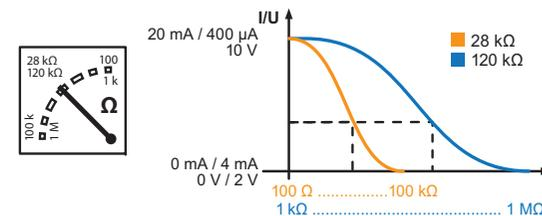
使用模拟输出计算绝缘电阻的:
