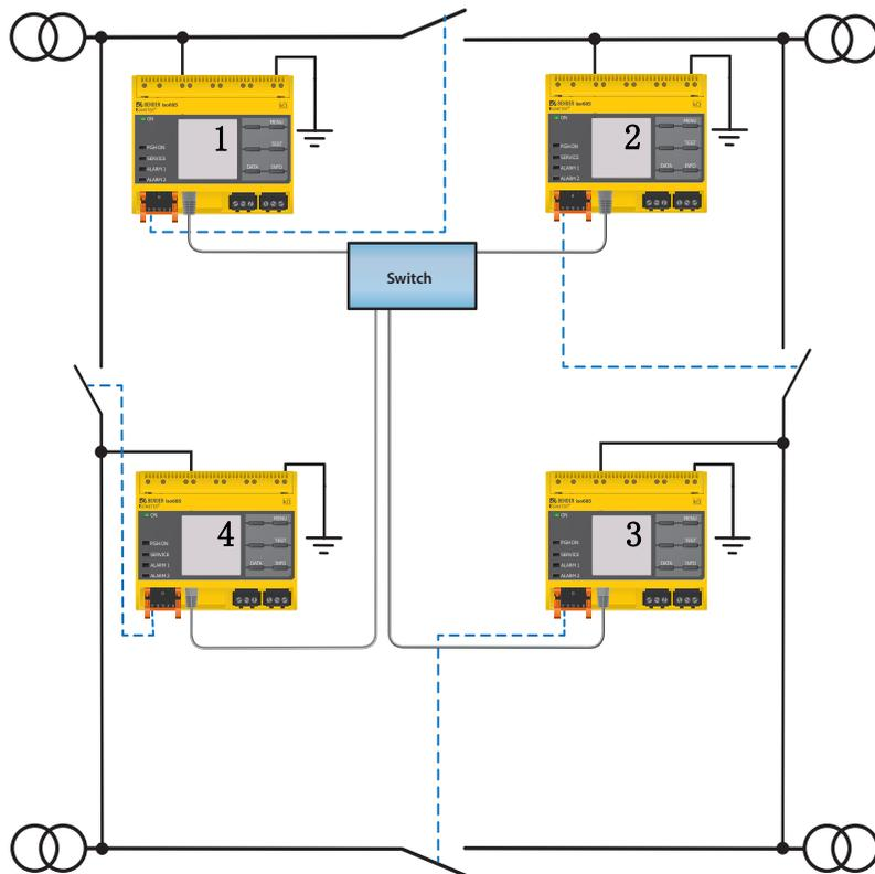
在群中，具有最低 BCOM 地址的测量设备（在示例中，设备 1）将其当前测量的绝缘值分配给所有群内设备（此处为设备 2）。参数“测量值订阅”可被用于定义相应的设备上是否显示此共享的测量值。如果激活这个功能，设备 2 将基于所选择的报警阈值来报告绝缘报警 1 和 2。默认情况下，功能是激活的。
