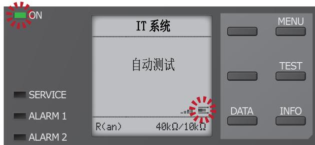
闪烁的“ON”LED 和进度条显示测量当前进程
