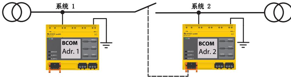
通过 X1 连接器，ISOMETER® 能被 IT 系统隔离并且测量功能不工作。因此，在使用中的数字输入的功能不得不设置为“无效设备”。
