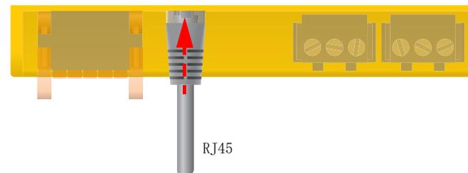
使用标准配线电缆（RJ45/ 无交叉电缆），通过开关连接到 STAR 拓扑中其他几个 ISOMEER® 或多个 互连的 ISOMEER®。
